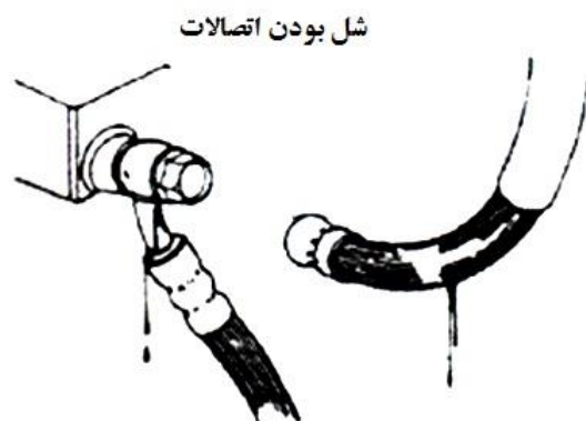
نشستی، صدمه دیدگی، و شل بودن شیلنگ‌های ترمز
