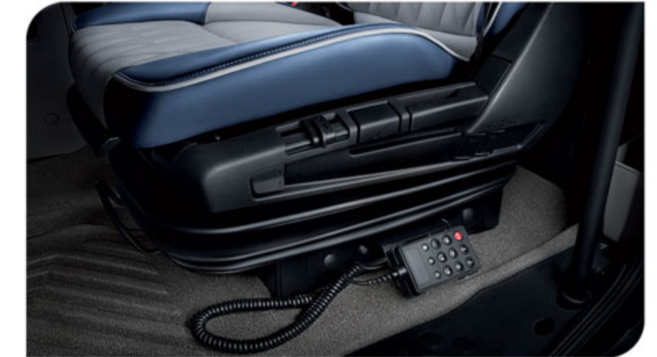
- صندلی راننده با سیستم تعلیق بادی و قابلیت تنظیم در ۶ جهت
