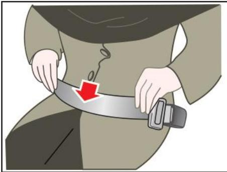
۳- برای بلندتر کردن تسمه کمربند، زبانه را تحت زاویه صحیح بکشید تا طول تسمه افزایش یابد.
